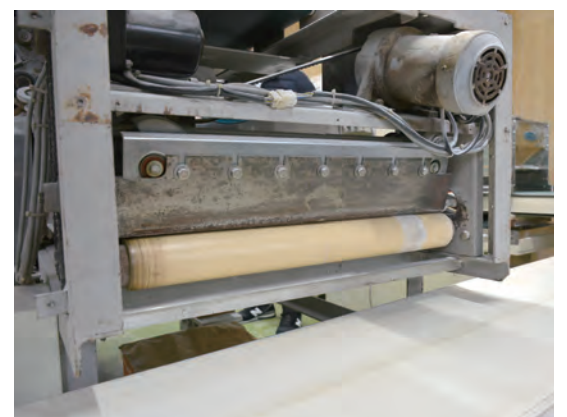
手打ち式の製麺機では最後に機械に取り付けた包丁刃で麺をカットします
