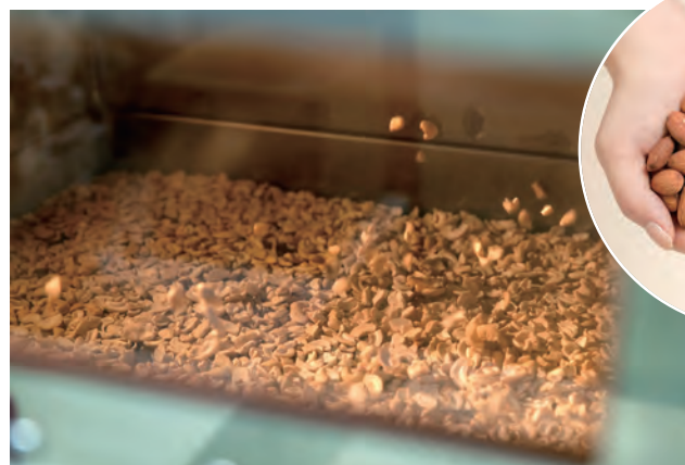
ナッツの種類や状態によって温度を微調整する熱風式焙煎
