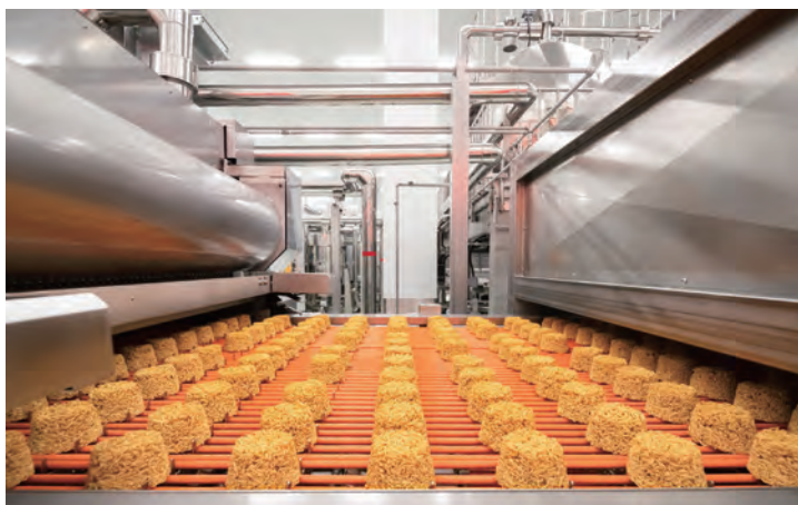
機械に小麦粉を入れるところから40分でカップ麺が完成。1日最大400万食生産できます
