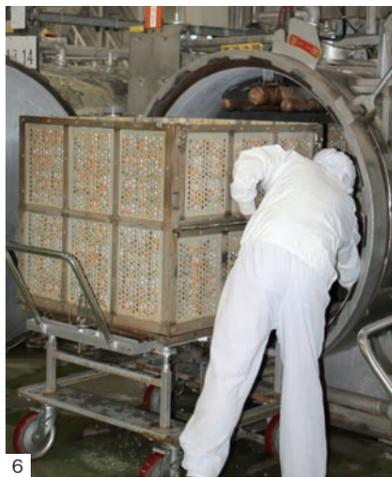
1 ゆでた大豆の湯切りをします。 2 異物や皮、割れ豆などを機械と手作業で除去。 3 1日で排出される廃棄物は約300kg。豚の飼料や肥料などに再利用されています。 4 大豆を計量しながら充填。 5 缶の中の空気を瞬時に抜き取り、高真空状態で密封します。 6 大きな窯の中に缶詰を入れ、加熱・殺菌しながら蒸し上げます。
