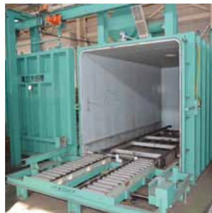
真空予冷装置：ブロッコリーは蕾(つぼみ)の集合体。花を咲かせようと変色してしまいます。そこで各生産者からセンターに届いたら、この真空予冷装置で急速に冷やし、「つぼみのまま」保冷車で迅速に運びます
