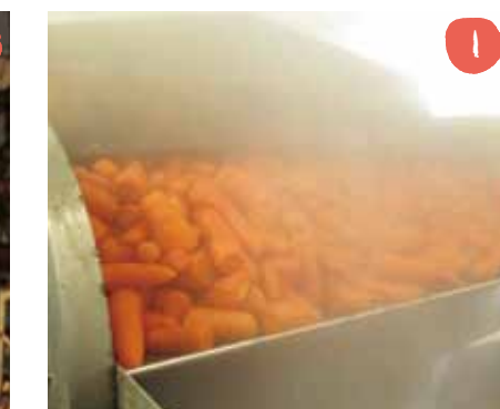
ブランチング：湯通しでアク抜きを行い、栄養成分を分解する酵素や変色を進める酵素の働きを抑制します
