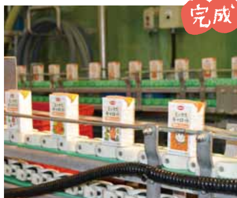
完成したミックスキャロットは一つひとつにストローが付けられ、賞味期限を印字。箱詰めされます
