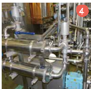
異物除去：フィルター、強力なマグネット、遠心力を使用して異物を取り除きます
