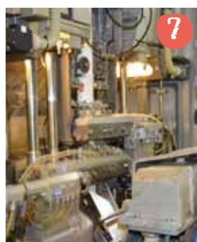
充填：常温で長期保存が可能な無菌充填方式を採用。殺菌処理した容器にジュースを詰めます
