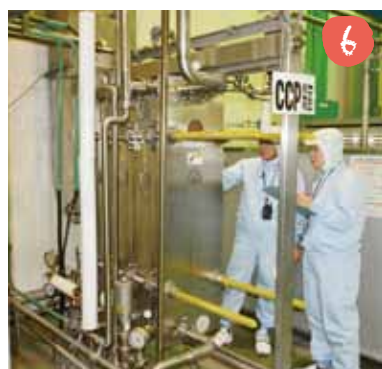
プレート式殺菌機：112℃で30秒間加熱殺菌し、20℃の常温まで急速に冷却します
