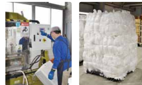
(左)発泡スチロールの圧縮作業、(右)圧縮された商品仕分け袋
