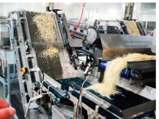
洗浄の行程に根とり機があります。コンベアの窪みを利用して根を取ります。根とり率は70~80%です。
